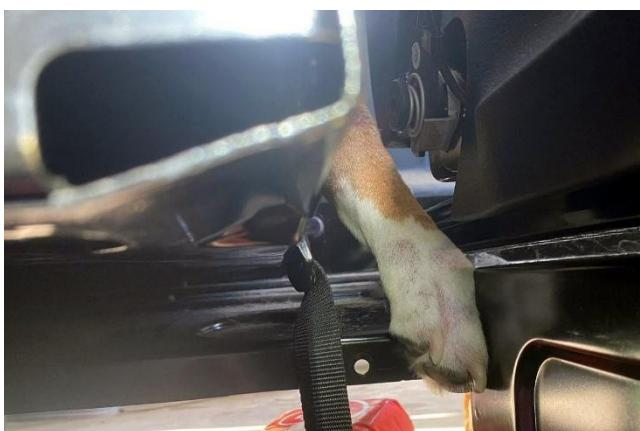
Zunächst haben wir die Trennwand zwischen Fahrgast- und Laderraum demontiert, um einen besseren Zugang zum Hund zu erhalten. Anschließend wurde mit einem Rotations-Multifunktionswerkzeug und einem Mini-Trennschleifer ein Blechstück herausgetrennt, so
